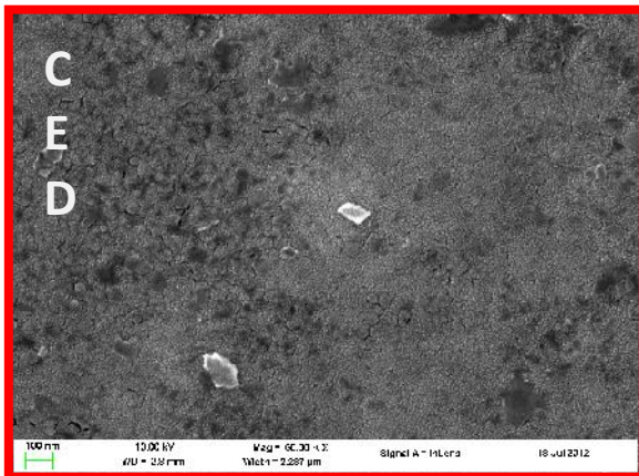
Gambar 8. Hasil FE-SEM morfologi deposit nikel mengandung natrium lauril sulfat 0,08 g/L + saccharin : 2-butyne-1,4-diol (2,0:0,2)g/L
