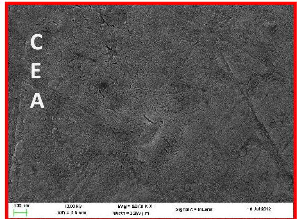
Gambar 5. Hasil FE-SEM morfologi deposit nikel mengandung natrium lauril sulfat 0,08 g/L + saccharin : 2-butyne-1,4-diol (0,5:0,05)g/L
